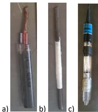
**Figura 8** a) Electrodo de trabajo (EPC SM) b) Electrodo auxiliar (barra de grafito ajustado a 1cm de largo) c) Electrodo de referencia de Calomel (KCl saturado).
