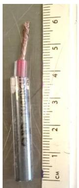
**Figura 9** Electrodo de pasta de carbono conformado por pasta de grafito empacado en tubos plásticos de PVC con cable incorporado.
