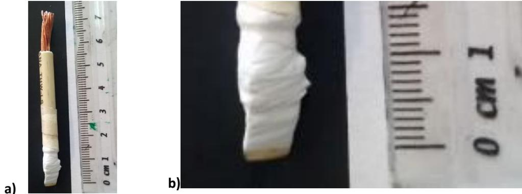
**Figura 34** Electrodo de trabajo de oro 24 Quilates a) electrodo completo b) acercamiento región que contiene oro
